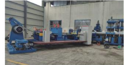
Location: China Jiangsu SS spiral pipe mill Pipe diameter: Φ219-Φ1420 mm Pipe thickness: 1.5-3.0 mm 地点：中国江苏 不锈钢螺旋管机 管径：Φ219-Φ1420 mm 壁厚：1.5-3.0 mm
