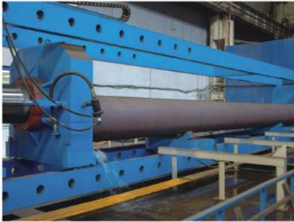
Location : Ukraine Pipe hydro tester Model : Ø219-1220 mm Pipe thickness 4.0-12mm 地点 : 乌克兰 水压试验机 型号 : Ø219-1220 mm 管厚 : 4.0-12mm
