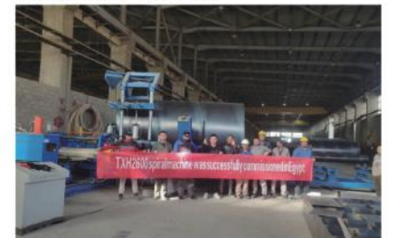
Location: Egypt Thin spiral pipe mill Model: Φ1400-Φ2600 mm Pipe thickness: 1.5-3.0 mm 位置：埃及 薄壁螺旋管机 型号：Φ1400-Φ2600mm 壁厚：1.5-3.0mm
