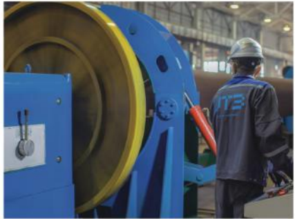
Location : Ukraine pipe beveling machine Model : Ø 219-Ø1220 mm Pipe thickness 4.0-12 mm 位置 : 乌克兰 管道坡口机 型号 : Ø219-Ø1220mm 管厚 : 4.0-12mm
