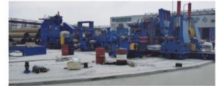
Location: China Baotou spiral pipe mill Model: Φ400-Φ2020mm Pipe thickness: 5.0-22 mm 地点：中国包头 螺旋管机 型号：Φ400-Φ2020mm 壁厚：5.0-22mm
